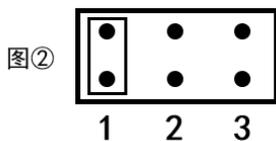
如图②所示。1 位置短接为**不带记忆功能**：市电断电后再来电也是断开状态。**【出厂默认】**
