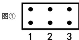
用户需自行调整开关内部跳线帽状态。**【警告：强电危险！严禁带电操作，当心触电！】**
