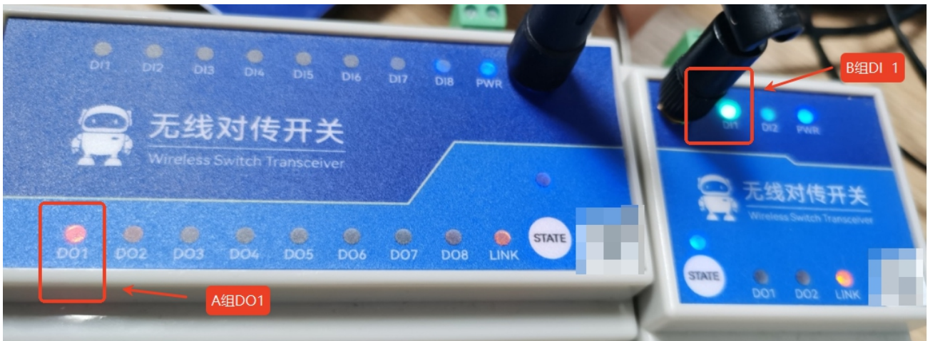
图 3-2-6 设备设置成功后，B 组 DI 1 控制 A 组 DO1 示意图
