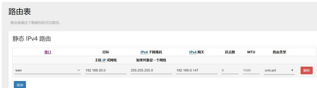
添加完毕后，应在 网络-->防火墙-->基本设置中将转发选项由拒绝变为接受，如下图所示。
