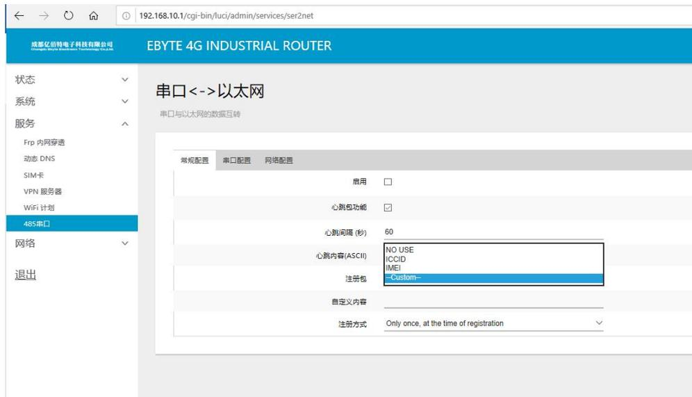
上图所示中，常规配置选项具备使能串口服务，以及使能心跳包的相关服务，这里我们默认都是没有打开的，但如果用户启用了串口服务，为了防止链接中断我们建议用户同时将心跳包功能开启，注册包中，可以选择注册方式，这里我们提供了 SIM 卡的 ICCID 以及 IMEI 作为注册包，当然用户也可以自定义注册包内容或者注册方式，另外需要说明的是注册包与心跳内容。
