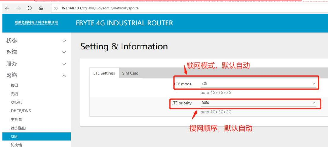
LTE mode 是锁网模式，客户可通过该选项切换当前的网络属性（4G/3G/2G），这里，需要说明的是，客户在切换网络时，一定要事先知晓当前电信提供商是否具备所设置的网段，例如，客户 A 使用的移动的 4G 卡，它将 LTE mode 设为 3G，出现的结果没有该服务（信号质量指示灯全部熄灭）。原因是移动卡已经撤了 3G 的网段，路由器无法搜索到相应的服务。
