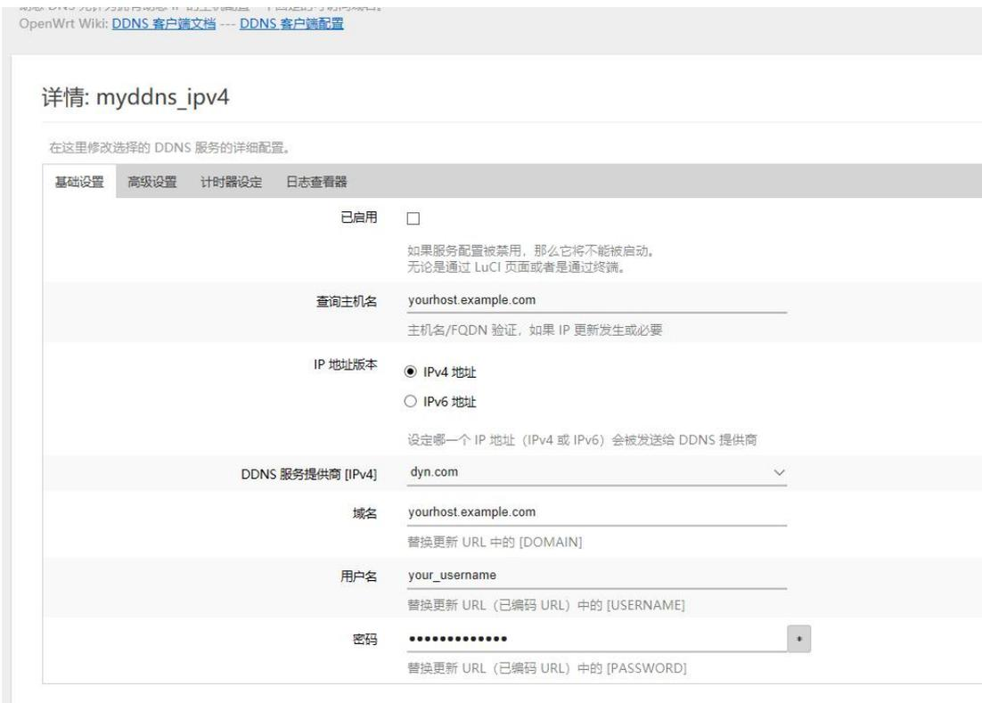
在动态设置界面中，DDNS 服务商中的下拉菜单中已经预配置好某些 DDNS 服务商，若客户选择的 DDNS 服务商不在下拉框中，可选择自定义。
