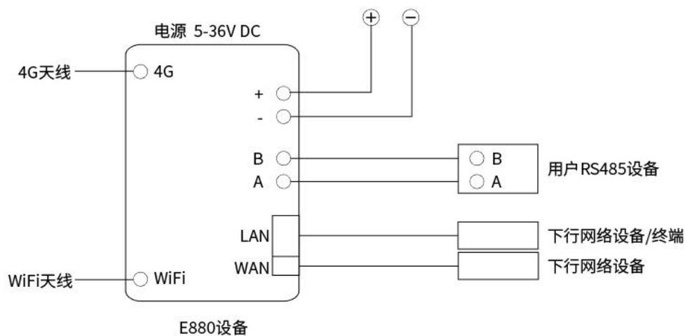
如上图所示，在设备加电之前（加电位置在面板处已有标识），客户务必需要将 4G SIM 卡插入值卡槽（芯片端朝上），否则 4G 功能将无法被启动。
