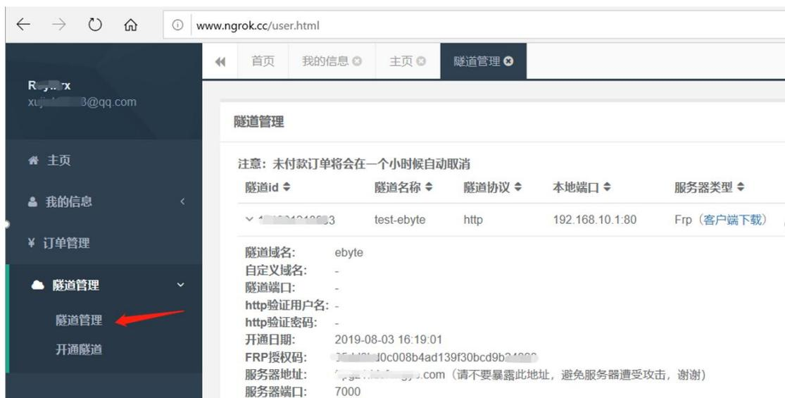
这里，我们会得到：1.隧道域名；2.隧道名称；3.FRP 授权码；4.服务器地址；5.服务器端口；6.隧道协议；7.本地端口。这些参数在后面我们路由器中 frp 客户端设置参数中需要用到。
