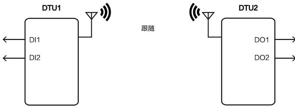
设备A的输入通道1变化，同时D1的蓝灯亮，设备B的继电器1相应的动作，同时D1的绿灯亮；
