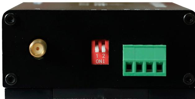
E830-DTU采集控制模式：M1M0=11，改变模式后需重新上电生效。
