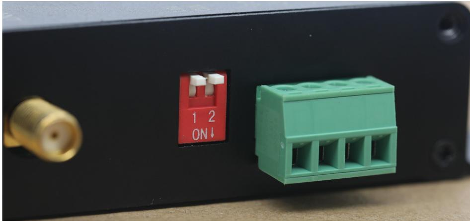
设备地址：是 DTU 当前的 Modbus 地址，范围为 0-248，值越小上位机搜索速度越快，值越大搜索速度越慢；当上位机改变地址后必须重新搜索地址才能更改其他参数生效。
