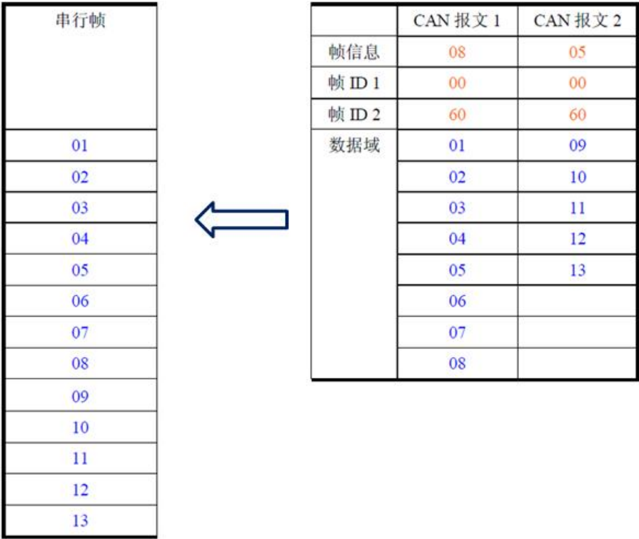
图 4.4 CAN 报文转串行帧示例（透明转换）
