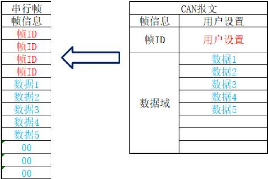
图 4.7 CAN 报文转串行帧（透明带信息转换）
