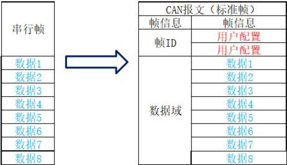
图 4.5 串行帧转换成 CAN 报文（透传带信息）
