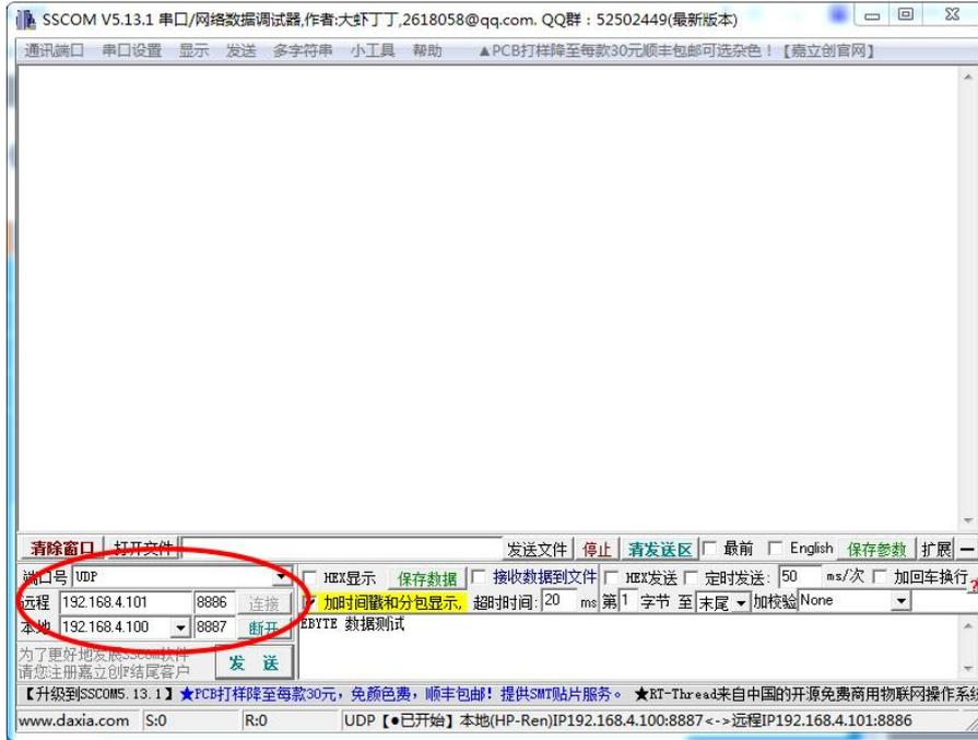
2、将设备 A 和设备 B 的 SOCKET A1 网络类型设置为 UDPC (UDP Client)，目标 IP 为 192.168.4.100，目标端口 8887。点击保存，重启模块。
