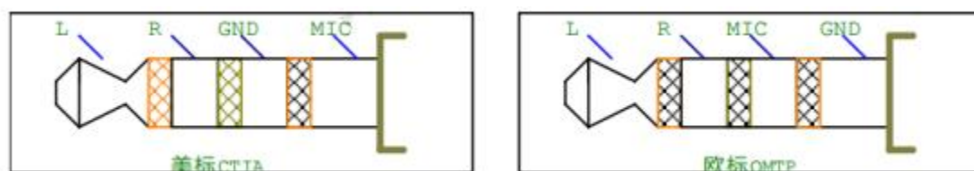
四段式耳机结构定义对比图
