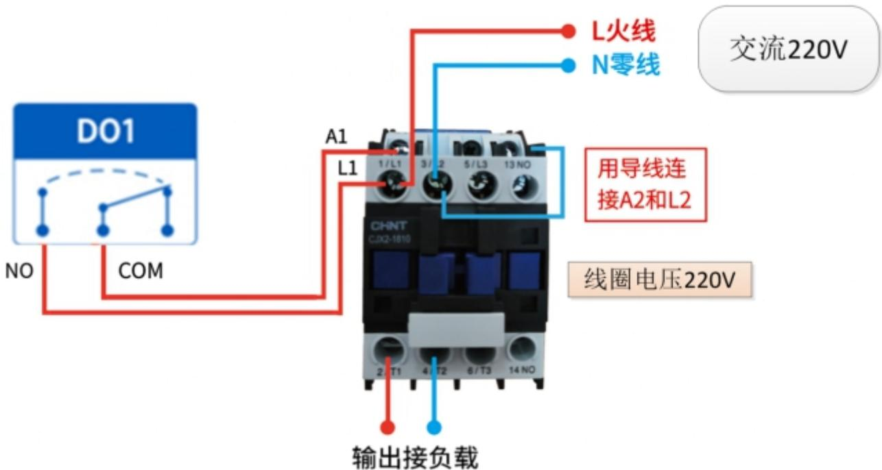
图 5-2-2 输出端控制接触器接线图
