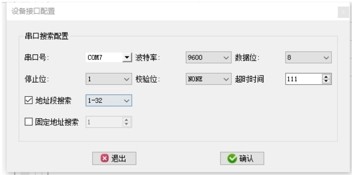
图 6-2-3 串口参数窗口界面
