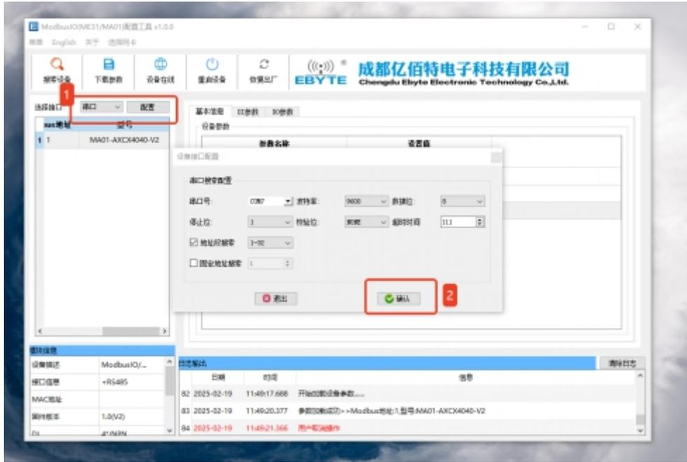
图 2-3-2 选择串口，打开配置界面
