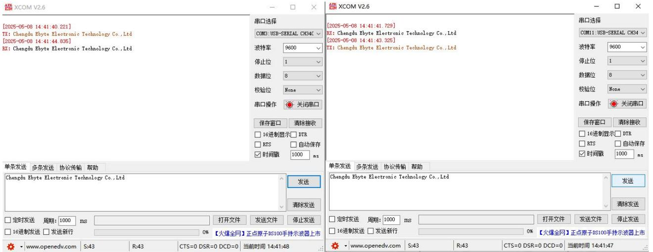
4、若客户需要修改参数请将数传电台拨于配置模式后与电脑相连，打开 E65\_E90-DTU(HD) 数传电台配置软件，即可修改相关参数，完成配置后务必恢复拨码开关状态方可进行通信。
