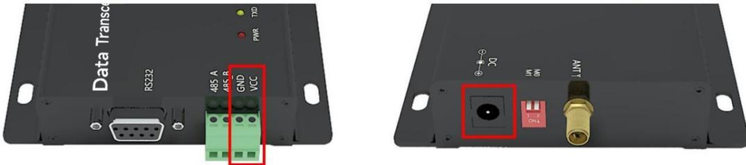
2、使用 USB 转 RS-232 或 USB 转 RS-485 使得电脑与数传电台相连；然后接通电台电源，电台将自动与另一个电台建立连接，连接成功 LINK 灯常亮即可进行通信。
