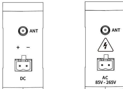
E95/E96-DTU(400SLxxx)可以使用 8~28V (DC) /85~265V (AC) 电源供电, 接线端口采用接线端子 (2 Pin) 连接。
