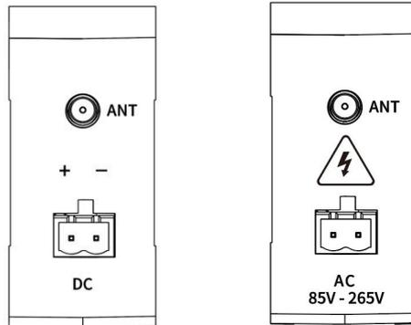
E95/E96-DTU(433Lxxx)可以使用 8~28V (DC) /85~265V (AC) 电源供电，接线端口采用接线端子 (2 Pin) 连接。
