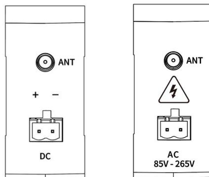
E95/E96-DTU(400Fxxx)可以使用 8~28V (DC) /85~265V (AC) 电源供电，接线端口采用接线端子 (2 Pin) 连接。
