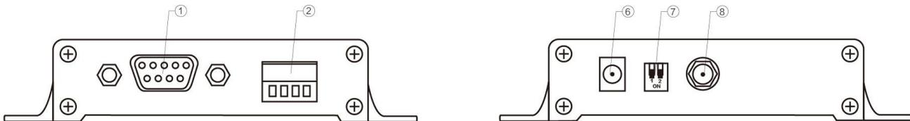
用户可以选择 ⑥ DC 电源接口供电，使用接口为外径 5.5mm、内径 2.5mm 电源适配器供电；亦可 ② 中的 VCC 端子与 GND 端子供电，只用选择任意其一供电方式即可；E90-DTU 可以使用 8~28V 直流电源供电，推荐使用 12V 或 24V 直流电源。
