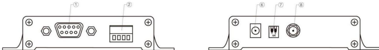
用户可以选择 ⑥ DC 电源接口供电，使用接口为外径 5.5mm、内径 2.5mm 电源适配器供电；亦可 ② 中的 VCC 端子与 GND 端子供电，只用选择任意其一供电方式即可；
