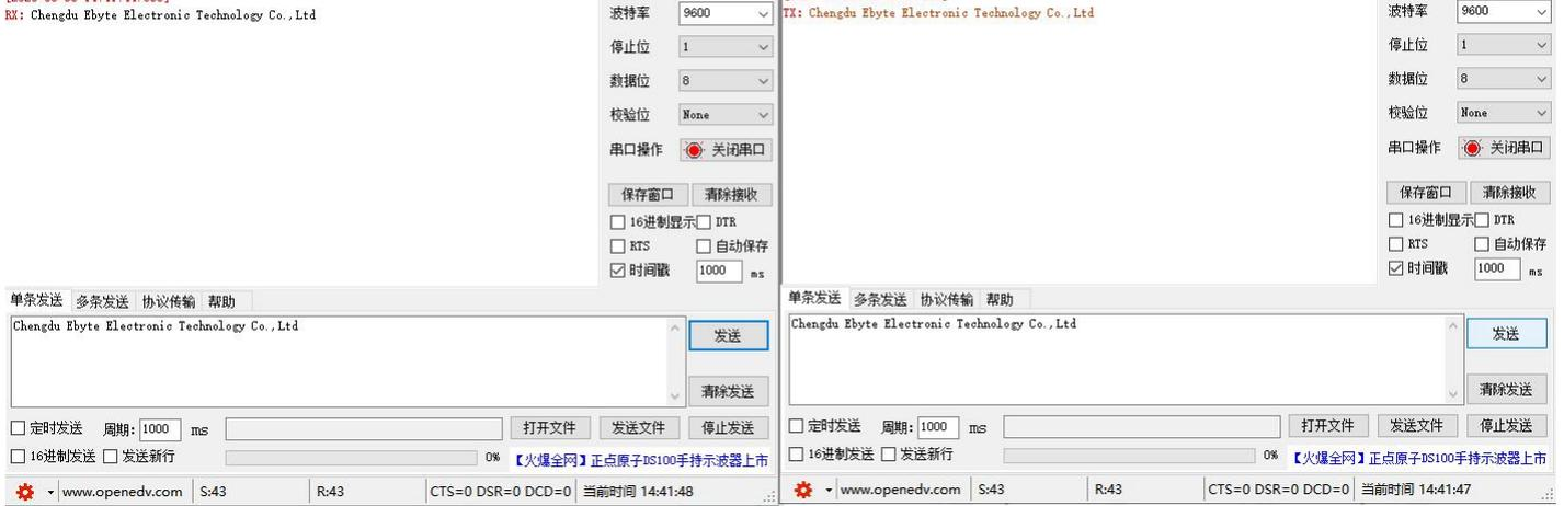
4、若客户需要修改参数请将数传电台拨于配置模式后与电脑相连，打开E62-DTU 数传电台配置软件，即可修改相关参数，完成配置后务必恢复拨码开关状态方可进行通信。
