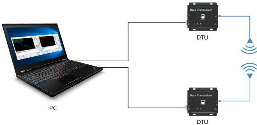
3、启动两个串口调试助手，选择串口波特率为 9600bps、校验方式为 8N1，即可实现串口透传；
