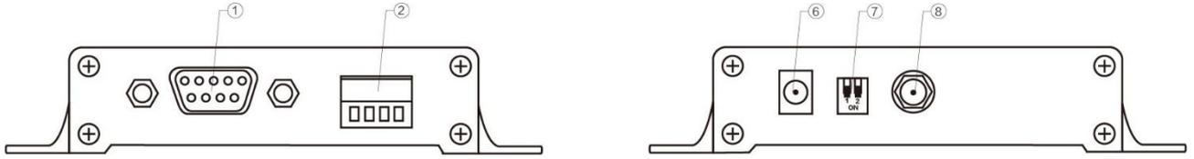
用户可以选择 ⑥ DC 电源接口供电，使用接口为外径 5.5mm、内径 2.5mm 电源适配器供电；亦可 ② 中的 VCC 端子与 GND 端子供电，只用选择任意其一供电方式即可；E32-DTU 可以使用 8~28V 直流电源供电，推荐使用 12V 或 24V 直流电源。
