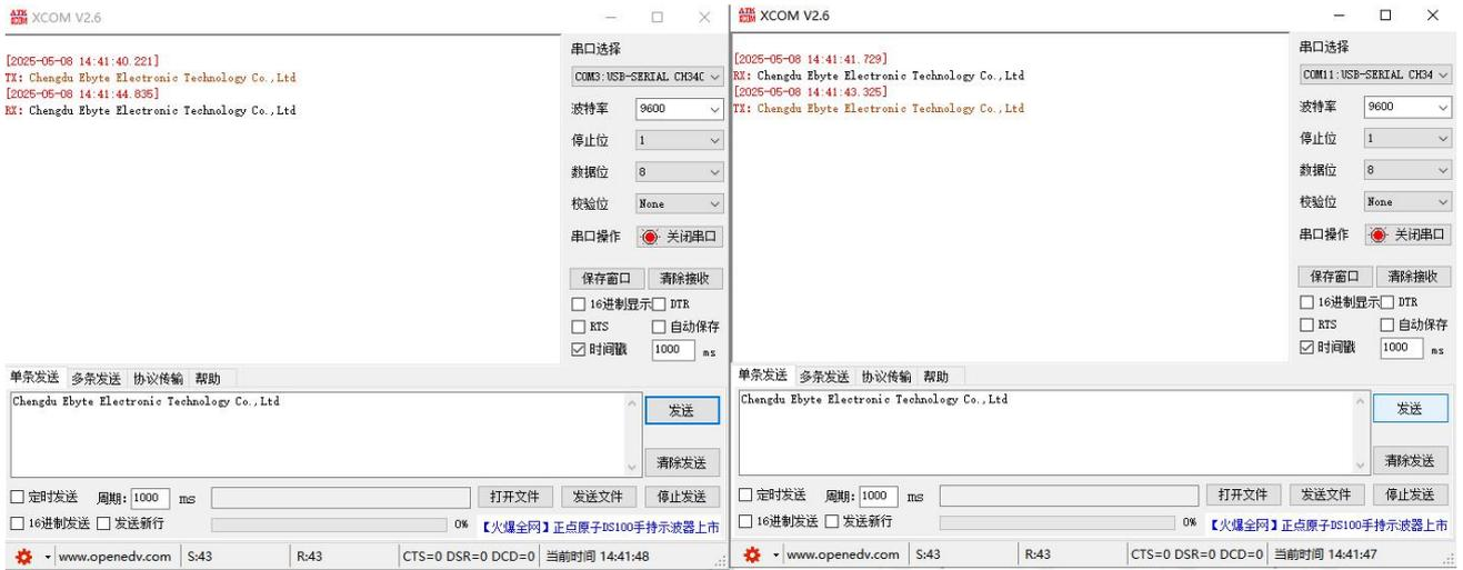
4、若客户需要修改参数请将数传电台拨于配置模式后与电脑相连，打开 E32-DTU 数传电台配置软件，即可修改相关参数，完成配置后务必恢复拨码开关状态方可进行通信。
