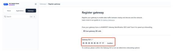
(3)输入 Gateway ID 和 Frequency plan,这里由于我们使用的网关和节点分别是 E870-L470LG11 和 E78-400TBL-02,所以我们 Frequency plan 选择 470 频段。这两个填写完成后点击最下方的"Register gateway"。
