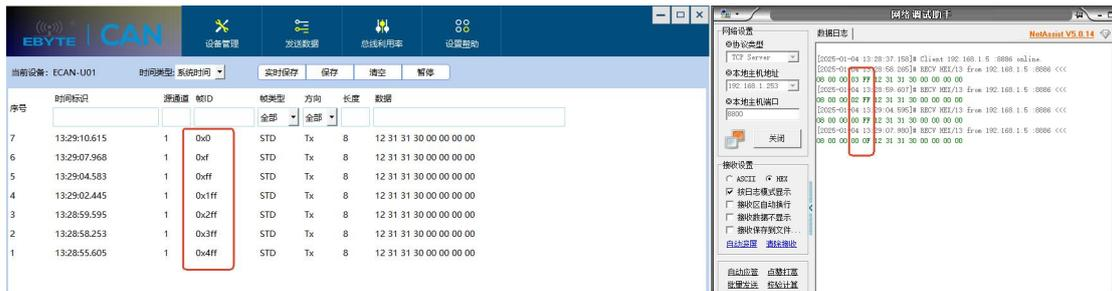
2、使用上位机配置过滤模式为标识符列表，位宽 32bit，ID: 1FFC0000，MASK: FFC0000，保存参数，重启设备；网络调试助手仅会收到 ID 为 7FF、3FF 的标准数据帧。
