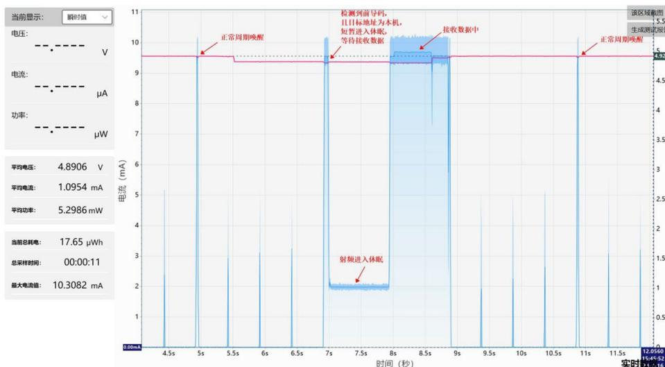
图 4 目标设备电流消耗图
