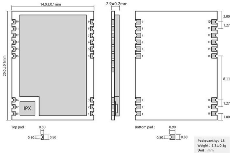
图 3-1 机械尺寸与引脚定义
