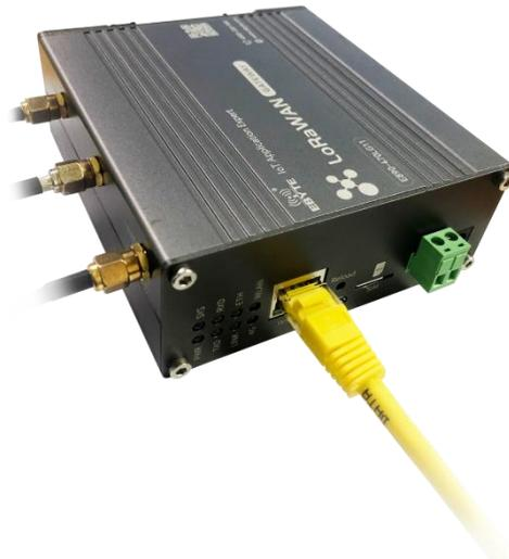
如上图所示，将 WIFI 天线，LoRa 天线，4G 天线分别接在设备面板标识下的 SMA 接口上，在设备加电之前（加电位置在面板处已有标识），客户务必需要将 4G SIM 卡插入值卡槽（芯片端朝上），否则 4G 功能将无法被启动。上述完成步骤后，使用设备配套的电源，然后给网关上电。将计算机与设备的 WIFI 相连接(WIFI 名字为 E890-XXXX)，设备 WAN 口接以太网（若验证 4G 功能，需不连接以太网）。
