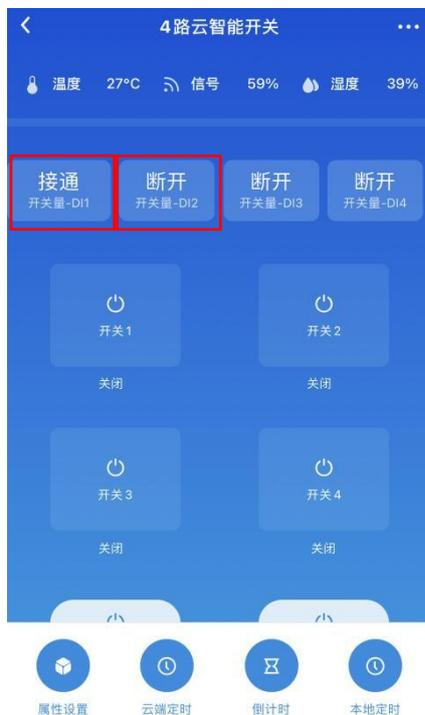
用户在 APP 上可设置输入状态对应的输出开关动作，例如：开关量 DI1“接通”，开关输出 1“打开”，开关输出 2“关闭”，从而实现自动化控制。
