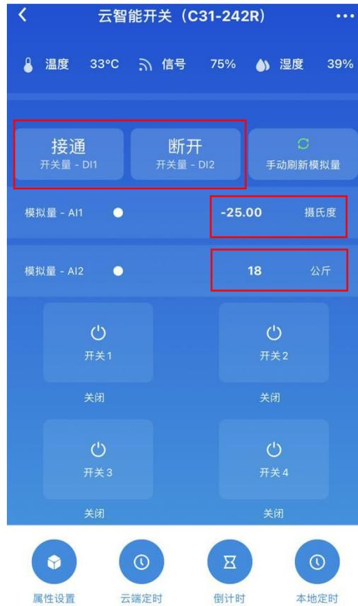
在手机 APP 上可设置传感器（模拟量）输入阈值，实现开关输出的打开或关闭，例如：当温度大于 41℃，开关输出 1“打开”，当温度低于 33℃，开关输出 1“关闭”，从而实现自动化控制。
