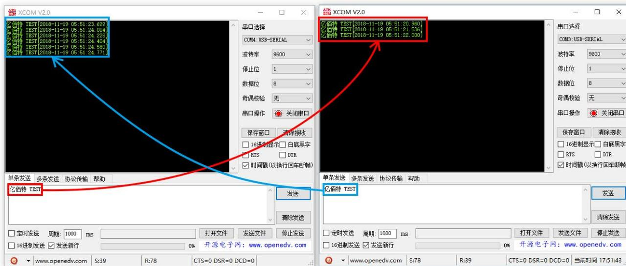
4、若客户需要修改参数请将数传电台拨于配置模式后与电脑相连，打开 E610-DTU 数传电台配置软件，即可修改相关参数，完成配置后务必恢复拨码开关状态方可进行通信。
