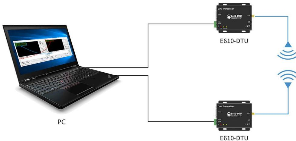
3、启动两个串口调试助手，选择串口波特率为 9600bps、校验方式为 8N1，即可实现串口透传；
