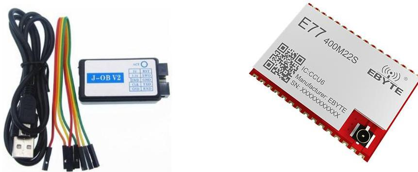
使用J-Link或STLink下载，再次下载需要使用带有RESET脚的下载器，因为该例程下载后模块处于低功耗模式。将下载器与模块连接好后打开LoRaWAN\_AT\_Slave\_V1.2\MDK-ARM中的keil工程，然后编译程序下载。
