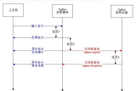
E180ZG120 模组在如果以广播的方式发送网络管理命令和 ZCL 发送命令时,由于受广播洪泛(flooding)的影响,发送确认会在反馈命令的 1 秒后才触发。因此使用该模组进行广播或组播时建议发送间隔周期大于 1 秒。
