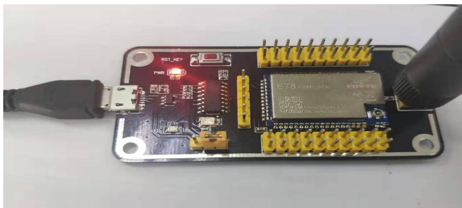
图所示，插接好跳线帽，选择 3.3V 供电，即可给模块供电，两个 E78-400TBL-01A 均如此配置，打开相应串口，即可收发数据。
