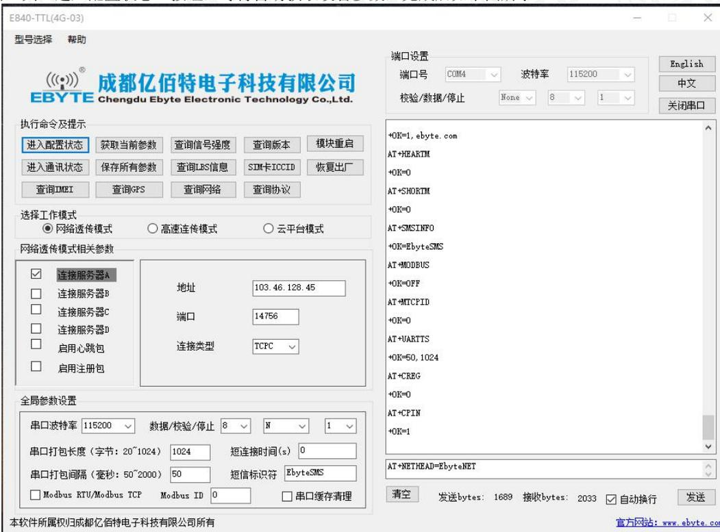
4、 查询信号强度，设置设备连接服务器 IP 及端口号分别为： 116.62.42.192, 8124; (亿佰特测试服务器)，最后点击“保存所有参数”，最后如下图所示：
