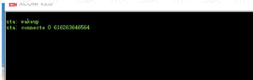
图表 七- 5 主机上电自动连接打印图
