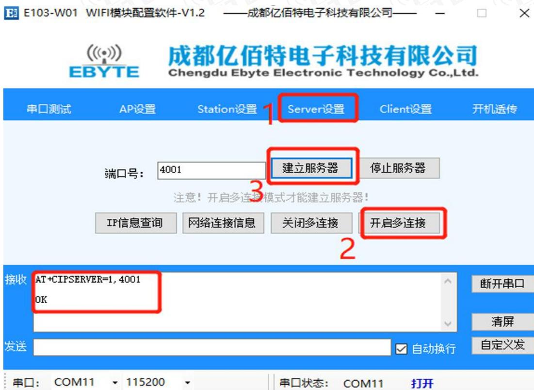
⑥. 我们在 PC 端建立客户端，并连接模块的客户端，然后可以发送数据，这里，如果服务器需要向客户端发数据，可以通过 `AT+CIPSEND=<link ID>,<length>`指令进行发送。这里用户可以在资料下载中下载 E103-W05 的 AT 指令说明手册，里面有详细的说明。
