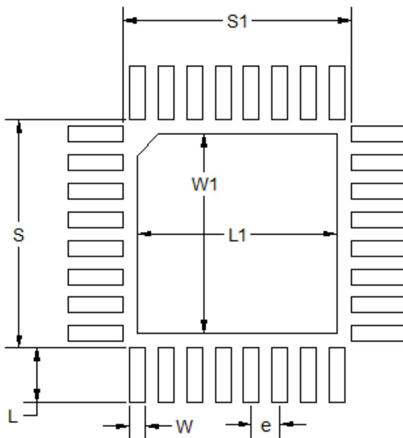
Figure 8.2. TQFN32 PCB Land Pattern Drawing
