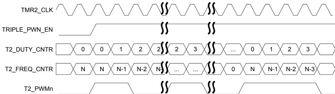
**Figure 49: Timer 2 PWM Timing Diagram**
