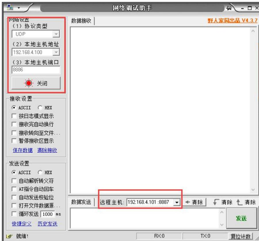
2、将设备 SOCKET A1 网络类型设置为 UDPS (UDP Server)，本地 IP 为 192.168.4.100，本地端口 8887。点击保存，重启模块。
