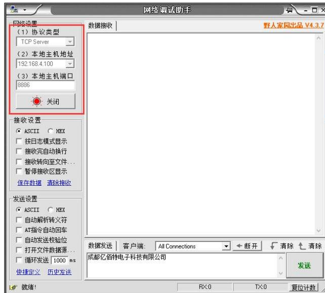
2、将设备 SOCKET A1 网络类型设置为 TCPC (TCP Client)，目的 IP 为 192.168.4.100，本地端口 0 (随机端口)，目的端口 8886。点击保存，重启模块。
