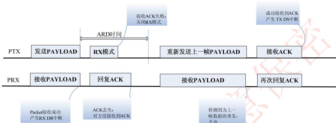
图 4-4 无 ACK PAYLOAD 通信模式
