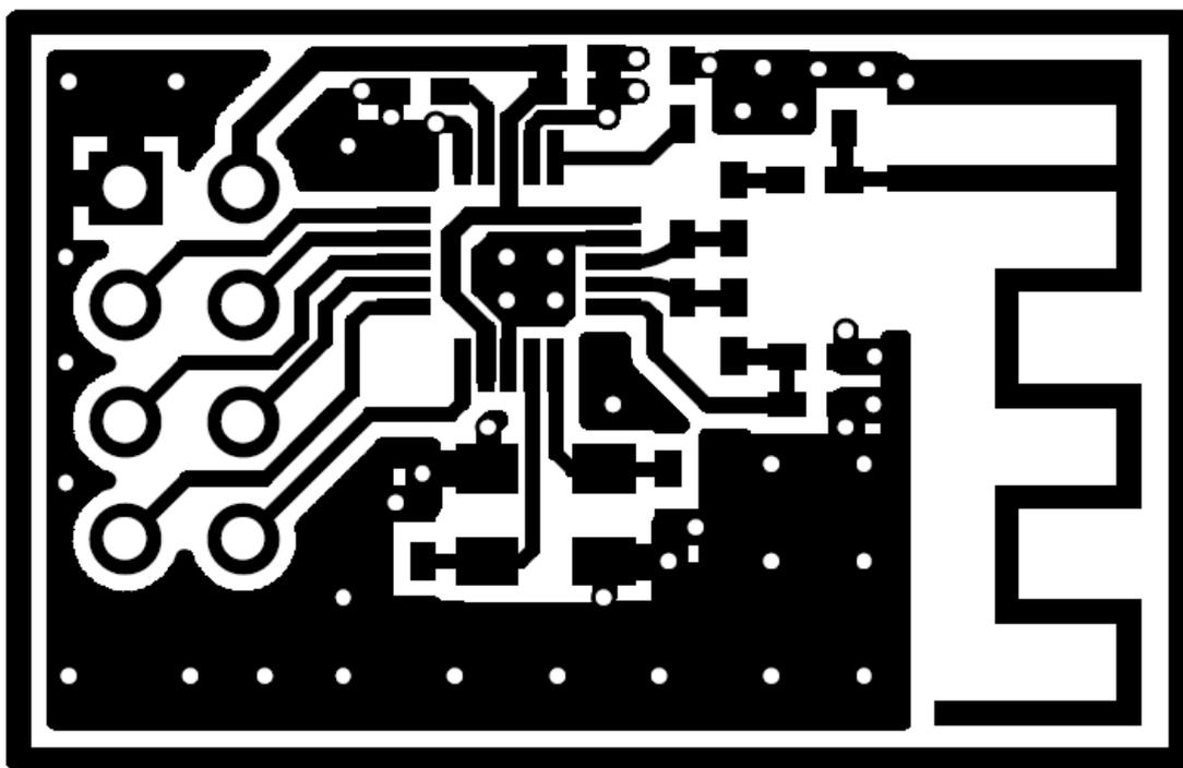
图 9-3 片上天线顶层布线图 (0402 元件)
