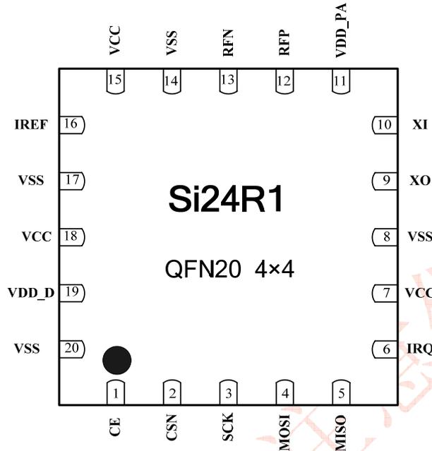
图 2-1 Si24R1 引脚信息图（QFN20 4×4 封装）
