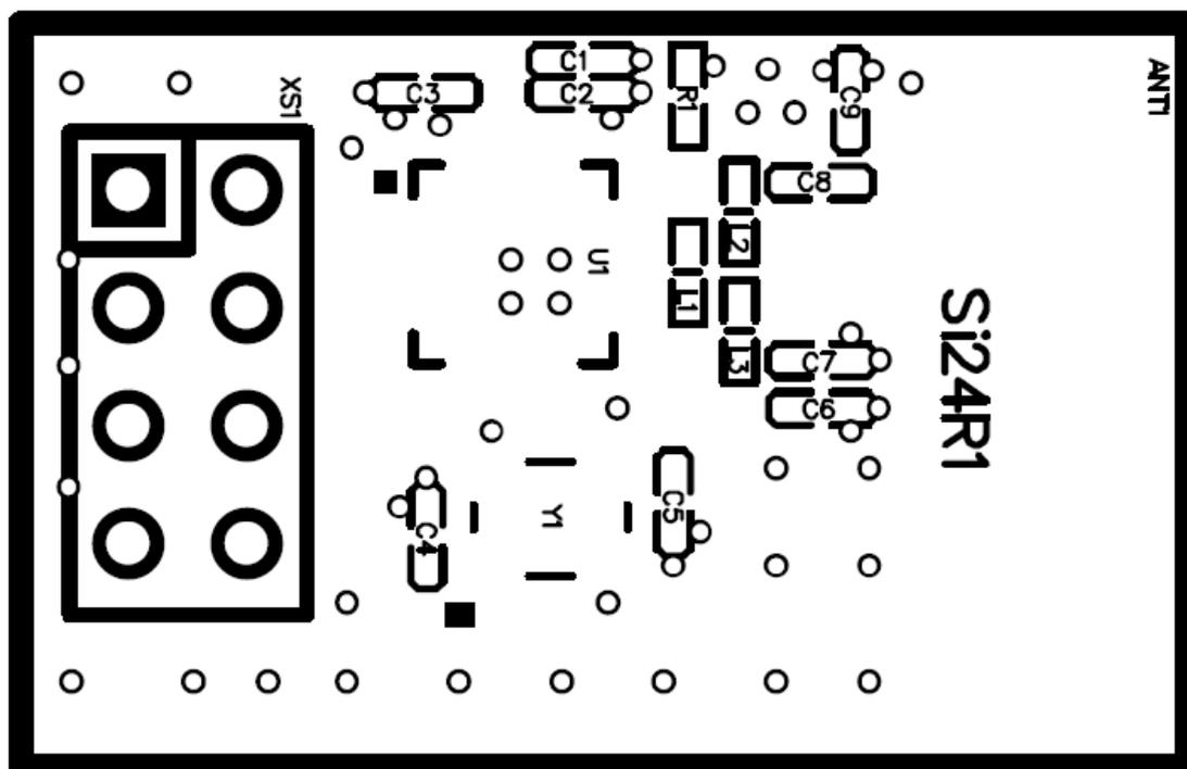
图 9-2 片上天线顶层丝印图 (0402 元件)
