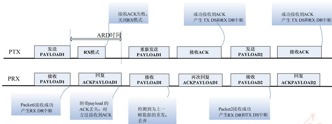
图 4-5 带 ACK PAYLOAD 通信模式
