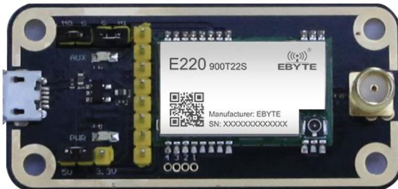
如图所示, 插接好跳线帽 (选择 5V 供电, 模式 0), 两个 E220-900TBL-01 均如此配置, 打开相应串口, 即可收发数据, 并可观察到底板 AUX 灯闪烁。
