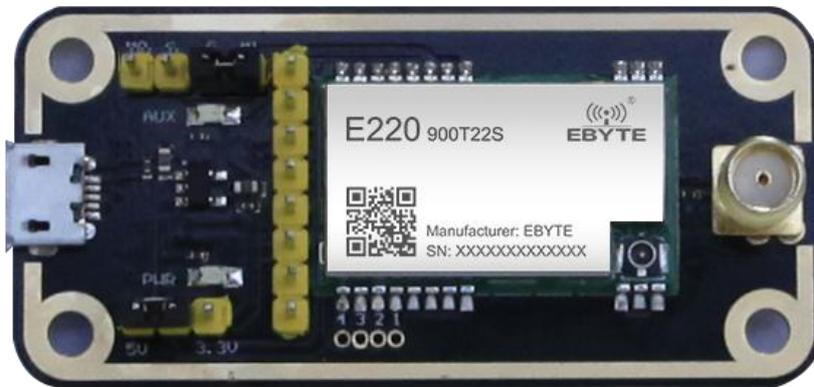
如图所示，插接好跳线帽（选择 5V 供电，模式 1），具体功能请参照相应的串口模块手册。
