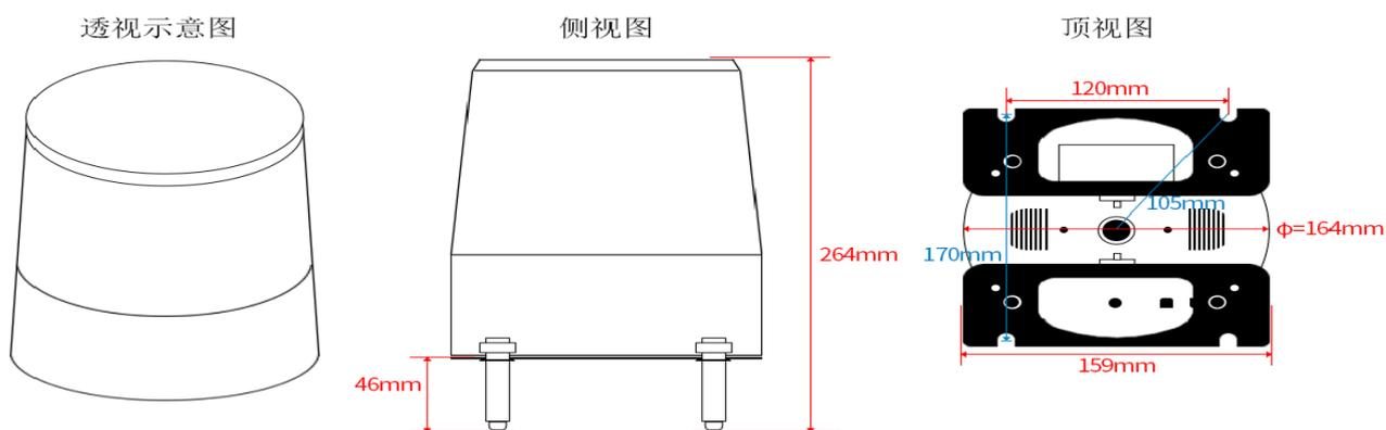
上图是传感器相应位置的尺寸图，您可根据尺寸，合理安装传感器。
