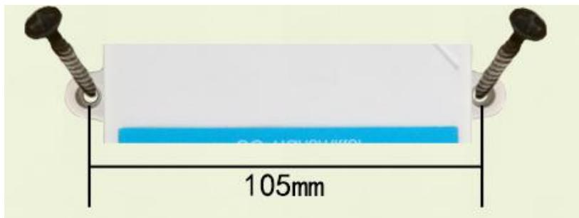
壁挂王字壳为壁挂式安装，安装孔位于设备两侧中部位置，安装孔径小于 4mm，孔距 105mm，可使用 3mm 的自攻螺丝安装。
