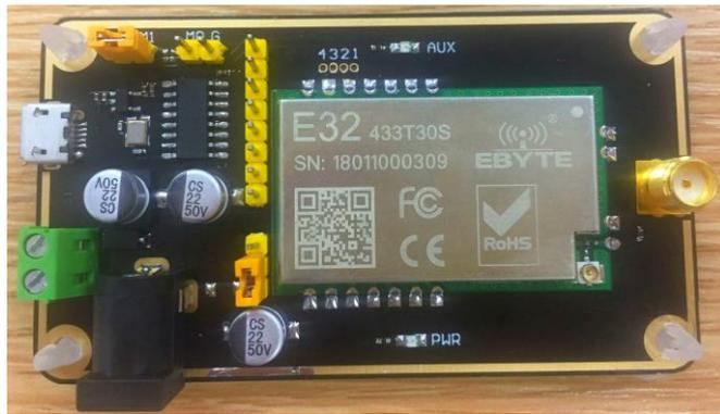
如图所示，插接好跳线帽（选择 5V 供电，模式 1），具体功能请参照相应的串口模块手册。
