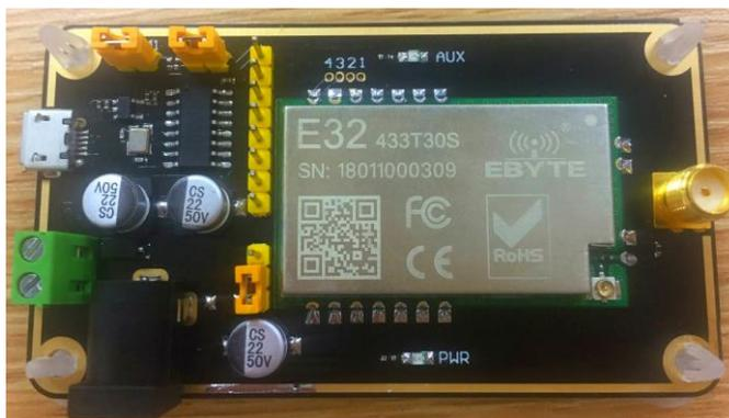
如图所示，插接好跳线帽（选择 5V 供电，模式 0），两个 EXX-XXXTBH-01 均如此配置，打开相应串口，即可收发数据，并可观察到底板 AUX 灯闪烁。
