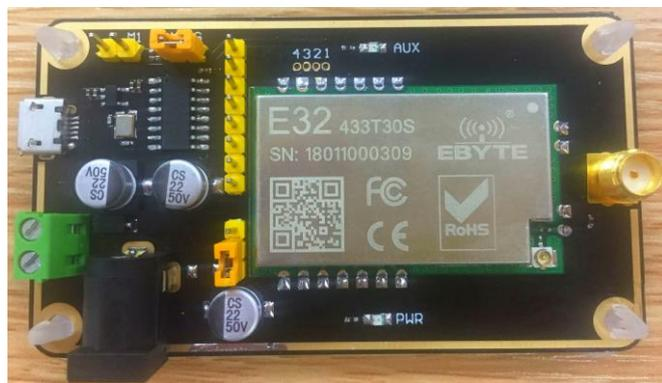
如图所示，插接好跳线帽（选择 5V 供电，模式 2），具体功能请参照相应的串口模块手册。
