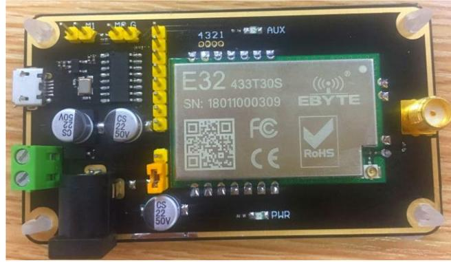
如图所示，插接好跳线帽（选择 5V 供电，模式 3），具体功能请参照相应的串口模块手册。
